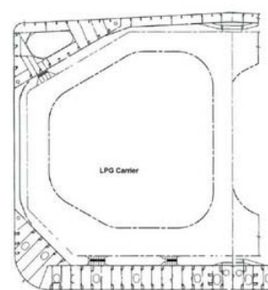
Рис. 6.8.2 Типовые поперечные сечения судов для перевозки сжиженных нефтяных газов
